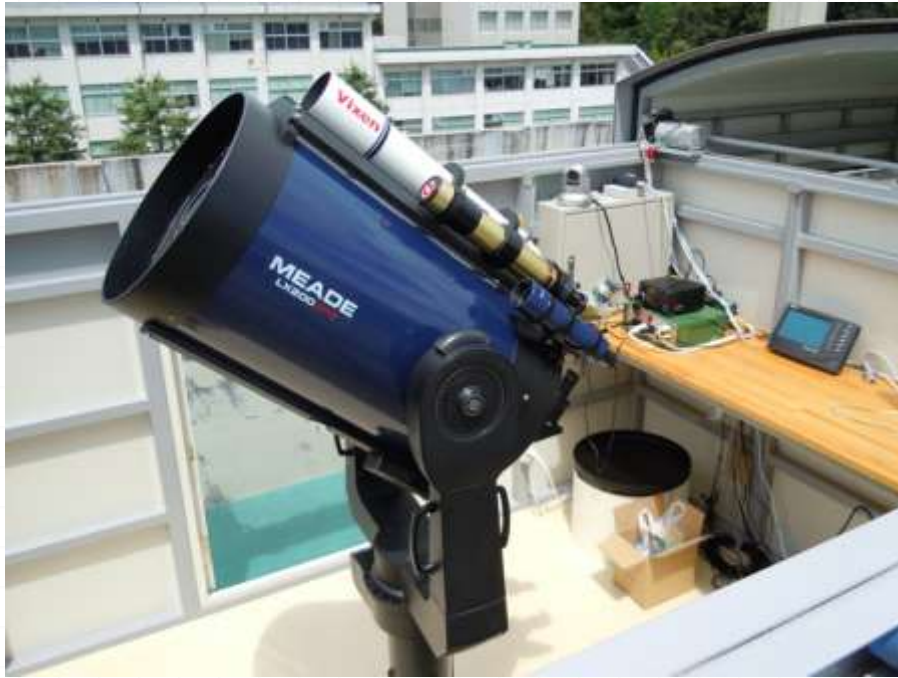
東天体観測室 口径35cm望遠鏡(経緯台) Meade LX200 GPS-35cm
