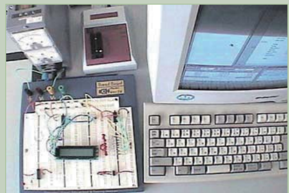
PICを用いて発光ダイオードや液晶表示装置を操作しています
