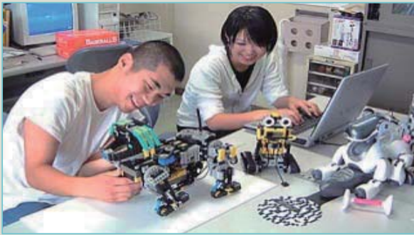
ビデオカメラを搭載した四足ロボットの試作機
